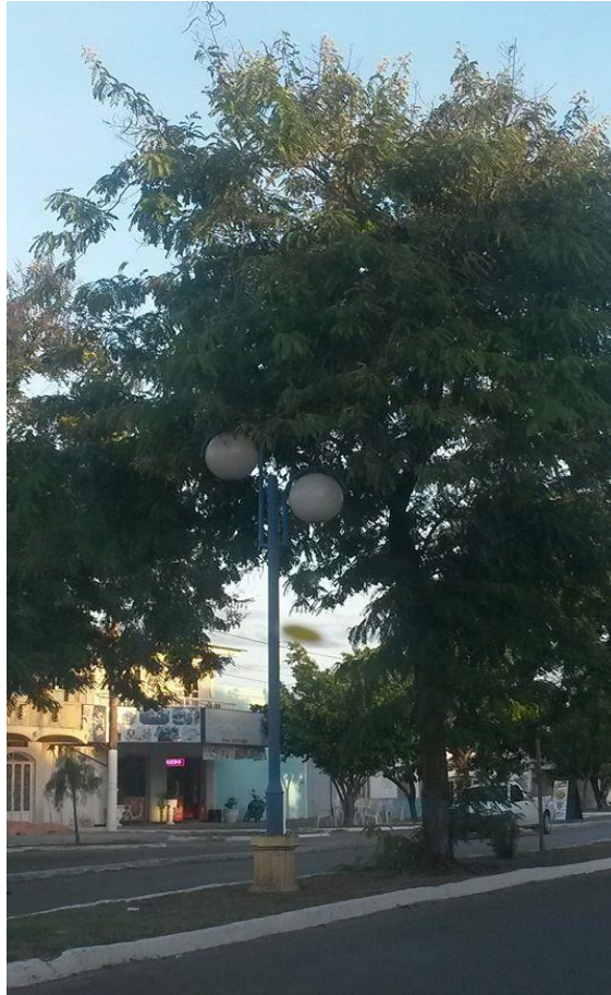
Figura 42: Arborização urbana de Corumbá, MS: luminária baixa implantada sob a copa da árvore, que diminui a frequência de necessidade de podas e mantém a via iluminada (Arquivo pessoal. 2014).
